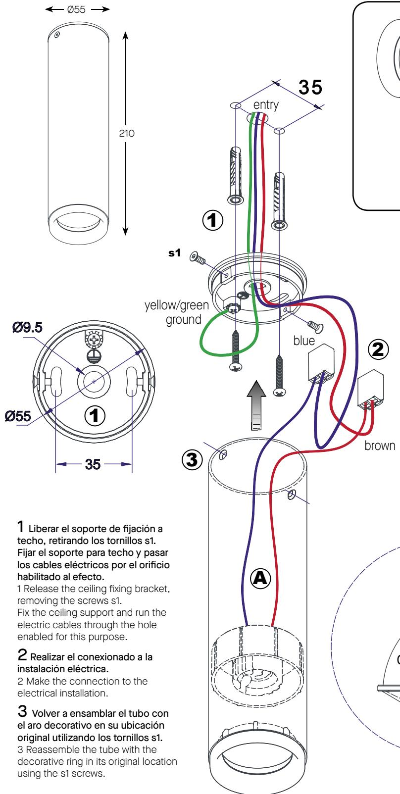
**1** Liberar el soporte de fijación a techo, retirando los tornillos s1.
