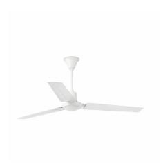
Ventilador de techo de líneas modernas ideal para habitaciones a partir de 17,6m2. Motor fabricado en acero y palas de acero. El acabado de las palas es blanco y son no reversibles. Accionado por regulador de pared, incluido. Dispone de 5 velocidades regulables con un consumo de 15,5 - 20,5 - 26 - 32,2 - 47,6W y 113 - 142 - 173 - 203 - 206 revoluciones por minuto según velocidad.
