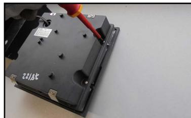
4. Desatornillar los tornillos posteriores de la luminaria.
