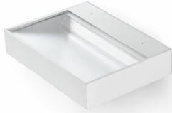
BLIT 210 es un aplique - bañador de color blanco, con una temperatura de color de 4000K, un CRI90 y una potencia de 20W. Este aplique tiene un reflector asimétrico, si lo colocas en vertical es perfecto como bañador de pared, mientras que si lo instalas en horizontal, es ideal como bañador de suelo.
