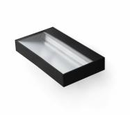
BLIT 300 es un aplique - bañador de color negro, con una temperatura de color de 4000K, un CRI90 y una potencia de 33W. Este aplique tiene un reflector asimétrico, si lo colocas en vertical es perfecto como bañador de pared, mientras que si lo instalas en horizontal, es ideal como bañador de suelo.
