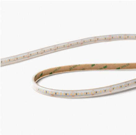
Tira LED 2835 9.6W 160LED/M IP66 2700K CRI80. La tira mide 5 metros pero puedes adaptar su medida haciendo cortes cada 50mm. Soluciones de iluminación diseñadas para los mercados globales, compatibles con las tensiones de red: 110 - 120V y 220 - 240V.
