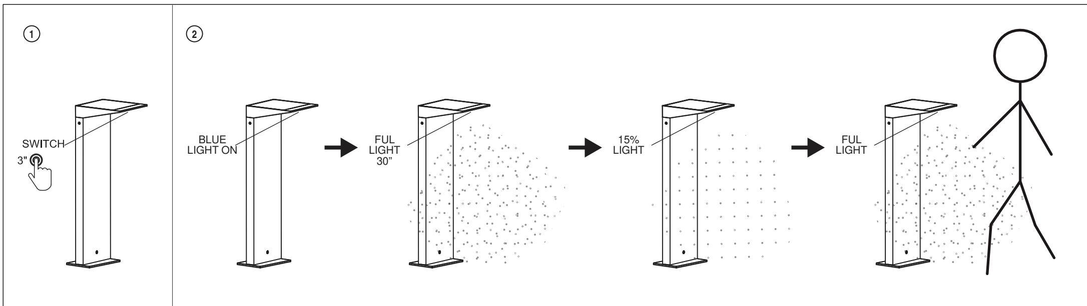
· **ESP** CONSIDERACIONES PREVIAS el área de detección que muestra el dibujo es el obtenido bajo el supuesto de colocación del sensor en condiciones óptimas, detectando un persona de complejión normal y una altura de 1,80m.
