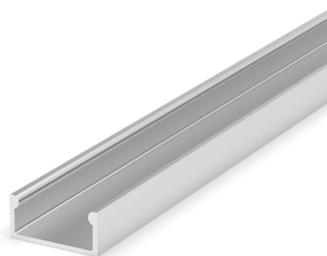
Perfil de superficie 8mm para instalación de tira LED. La protege contra golpes humedad y polvo. Difusor no incluido, compatible con el difusor opal 08060102, con el difusor transparente 08060103 y las tapas 08060104. Los perfiles se pueden cortar a medida desde los 0,10 metros hasta los 2. Este perfil es perfecto para las instalaciones de tira de LED en armarios, escaleras, etc.
